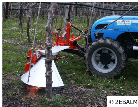
Photo 1 : Désherbeurs thermiques Désherbage dans une vigne
